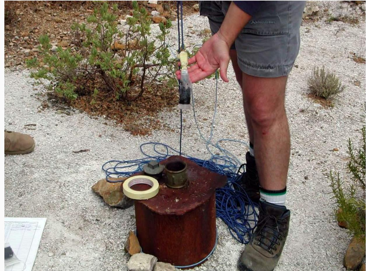
La instalaciones básicas para caracterizar el flujo (dirección y sentido) en los acuíferos son los sondeos piezométricos (o, simplemente, “piezómetros”)
